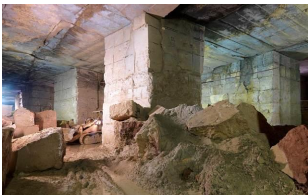
Interno di una cava di Pietra di Vicenza con accumuli di blocchi informi e limi di segagione.
